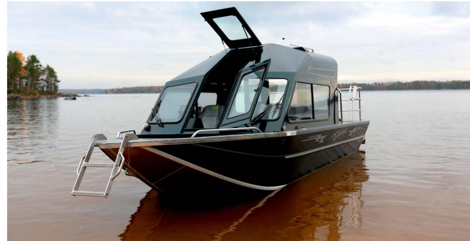
Моторный отсек высоким островком замыкает кокпит с кормы. Палуба этого своеобразного юта защищена релингами, большой центральный люк открывает доступ к двигателю, а люки по бортам — к рундукам и местам монтажа различных систем, в том числе и электрической.
